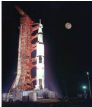
Il razzo Saturn V pronto per il lancio nella base di Cape Kennedy in Florida. Consiste di tre stadi del peso totale di 2850 tonnellate e di un'altezza di 111 metri.
