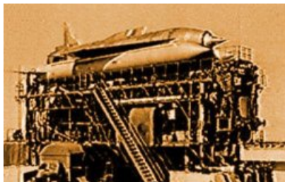
Il missile Burya: dal 1957 al 1960 furono compiute ben 18 prove di volo. Era lanciato verticalmente e i due acceleratori si sganciavano dopo 50 secondi dal decollo. Il missile poteva correggere la sua traiettoria in modo automatico, basandosi sulla posizione degli astri. Alcune caratteristiche tecniche: lunghezza 20 metri; diametro della carlinga 2,2 metri; altezza 6,6 metri; apertura alare 7,8 metri; massima distanza percorribile 6500 Km.
