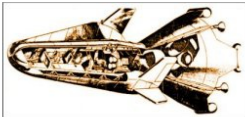
Il Lunex Lunar Lander dell'USAF, concepito per il rientro sulla Terra, dopo essere stato portato in orbita da un missile per raggiungere la Luna. Poteva ospitare tre cosmonauti ed era mosso da un motore avente ossigeno ed idrogeno come materiale per la combustione. Il cargo aveva una lunghezza di 16,2 metri ed aveva un diametro massimo di 7,2 metri, con un peso di 61.000 Kg. Era stato studiato inoltre per un atterraggio morbido.
